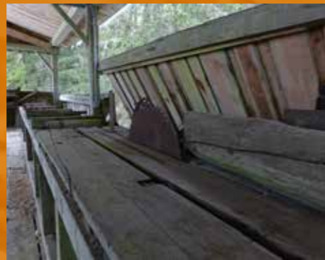
Le banc de délignage : une déligneuse à lame circulaire permettait d'enlever les parties de bois non utilisables (écorce, aubier).
