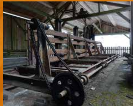
La scie battante avec son chariot pour la découpe des grumes : le cœur de la scierie.
